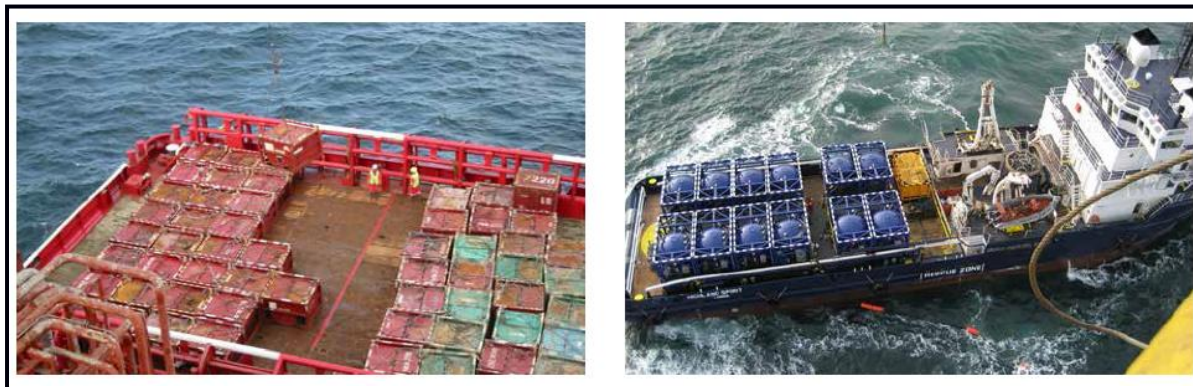
Figura 4.5. Transportul detritusului din foraj marin (schip și vas și furtun de transfer și habe/rezervoare)
